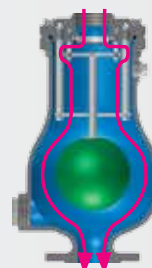
Purga de aire en carga.
