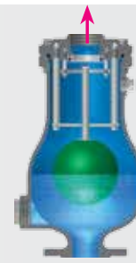
Admisión de grandes cantidades de aire durante el vaciado.
