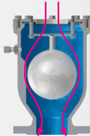
VACIADO DE LA TUBERÍA
